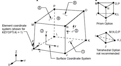
Figure 7 : Solid 45 Element , ANSYS Manual.
